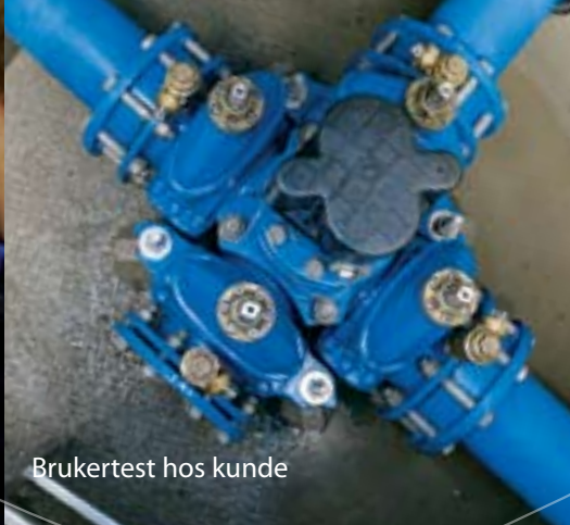
Etter levetidstest på 2500 operasjoner er ventilen fullt operativ
